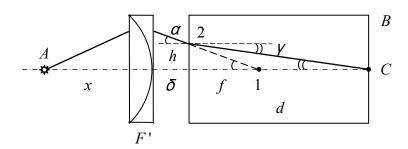
Мысленно проведём через вершину стеклянной линзы плоскость, перпендикулярную оси цилиндра. В результате получим систему двух соприкасающихся линз, одна из которых — исходная стеклянная линза, а другая — плосковогнутая рассеивающая линза, заполненная жидкостью. Для того чтобы найти фокусное расстояние F' составной системы в воздухе, воспользуемся тем фактом, что оптические силы соприкасающихся линз складываются:
