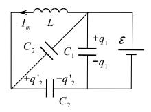
где  $\Delta q$  — заряд, прошедший через батарею в направлении действия её ЭДС. Так как заряд конденсатора  $C_1$  не изменился,  $\Delta q$  определяется зарядами отрицательной обкладки нижнего конденсатора  $C_2$ . Получаем:
