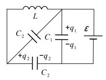
Поскольку в правом контуре нет индуктивности и сопротивление всех элементов цепи предполагается очень малым, можно считать, что сразу после замыкания ключа на конденсаторах устанавливаются некоторые начальные заряды  $q_1$  и  $q_2$ . При этом, из–за действия ЭДС самоиндукции, ток через катушку всё ещё равен нулю. Учитывая, что напряжение на каждом из конденсаторов  $C_2$  равно  $\varepsilon/2$ , получаем:
