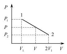
Обозначим через P и V давление и объём газа в промежуточном состоянии. На отрезке 1-2 эти величины связаны линейным соотношением:
